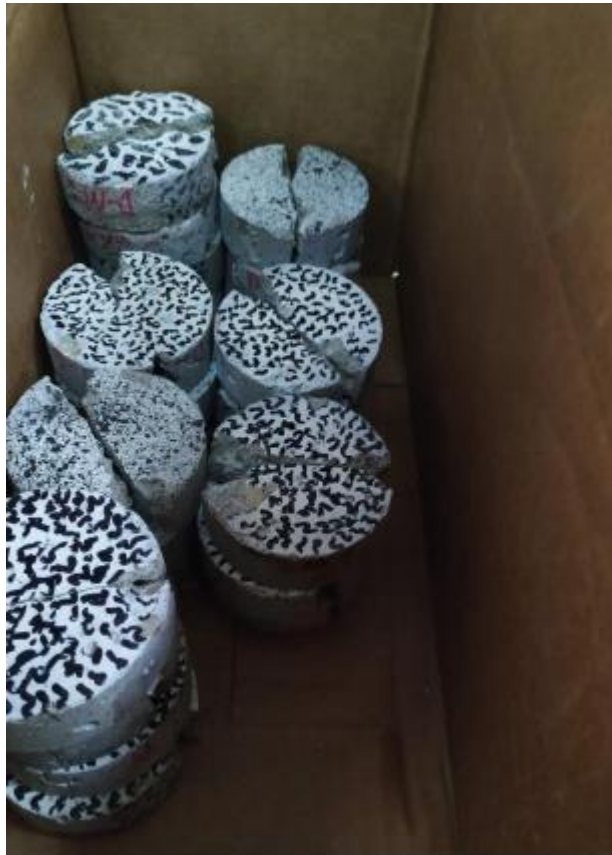
Figura 2 – Amostras já rompidas após os ensaios
